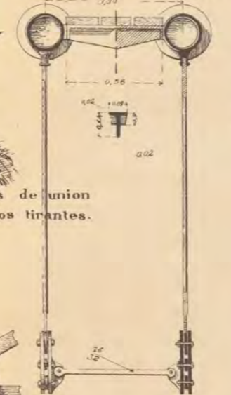
Corte transversal. Por el eje de los tubos. Por el eje de las péndolas.
