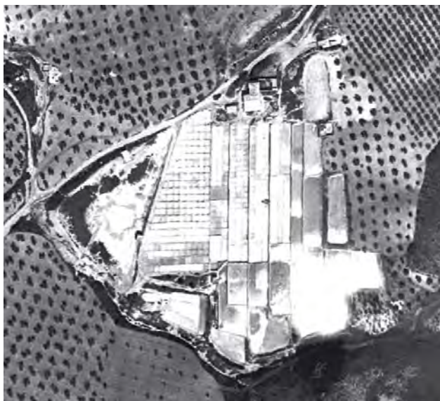
Figura 223. Trazado original de las eras de evaporación y calentadores en Salinas de Lagartijo, Jaén. 1979
