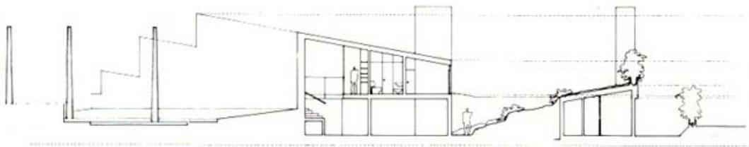
Casa Echevarría. Sección por el patio de relación y por el pabellón de servicio cubierto por el jardín elevado. Plano publicado en "Sáenz de Oíza, 1946-1988", El croquis 32/33, Reedición revisada y ampliada, 2002
