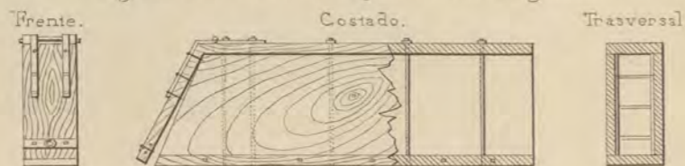
Fig. 12. Canales de desagüe en las ataguías.
