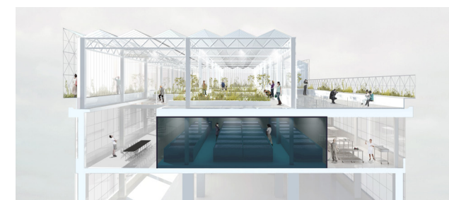
FIG 11. Sección collage de la transformación de la cubierta y de la sexta planta en granja urbana. Urban Farmers De Schilde. Space & Matter / Collage section of the transformation of the roof and the sixth floor into an urban farm. Urban Farmers De Schilde. Space & Matter [Imagen / Image Space & Matter]
