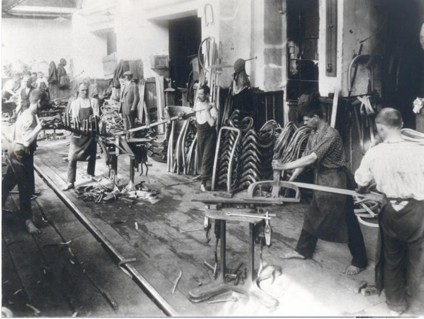
[Fig 3] Proceso de curvado de la madera en la factoría Thonet, Koritschan (Moravia)
