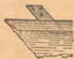
Fig. 152 — Grapa soldada en la parte inferior de las planchas y clavada sobre el enlatado en casos de fuertes pendientes.
