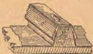
Fig. 157.—Cubrejunta sujeta con clavos recubiertos de aletas de zinc, soldadas en su contorno con la cubrejunta.
