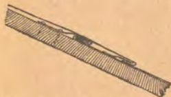
Fig. 156.—Sección transversal según AB (figura precedente), que enseña el empalme y el recubrimiento de las chapas.
