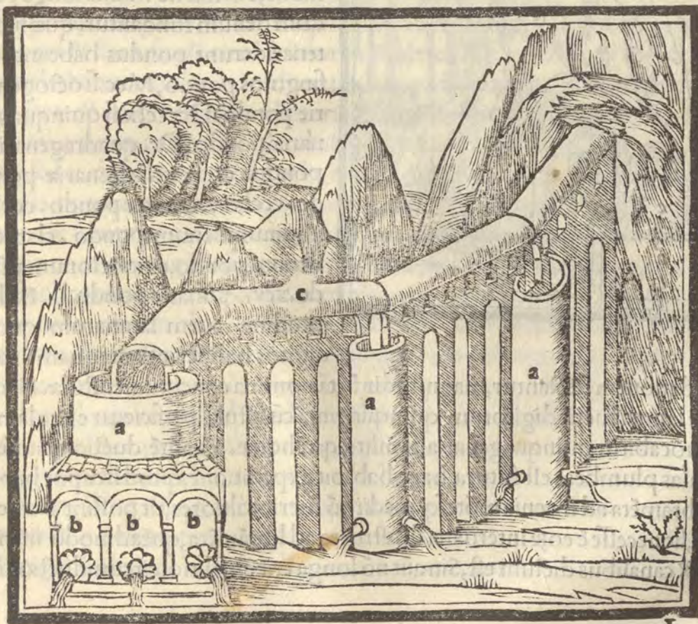
a. castellum b. triplex immissarium c. fornix
