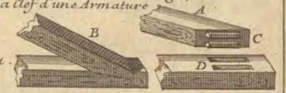
A. par Embrevement B. par entailles C. deux Ténons frotans D. deux Mortoises.
