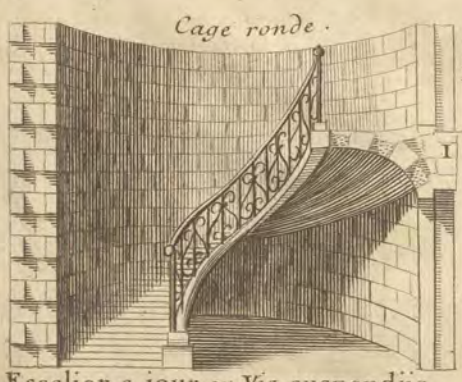
Escalier a jour ou Vis suspendue.
